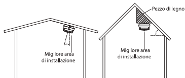
Figura 6-3 Posizione di installazione (2)
